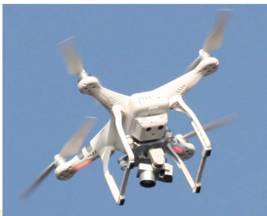
写真1 飛行中のドローン。機体が傾いてもカメラは同じ方向に保たれる。
