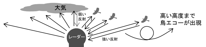
図3. 側面からの鳥の反射をレーダーが受け取ると、その鳥までの距離を「高さ」と判断してしまうので、実際は低いところを飛んでいても、高いところを飛んでいたと表示してしまう可能性がある。
