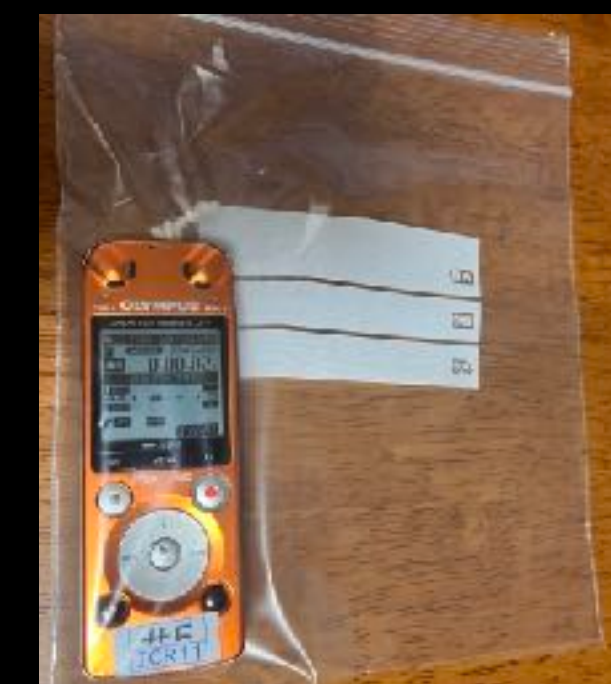
ジップロックにICレコーダを入れて防水加工
