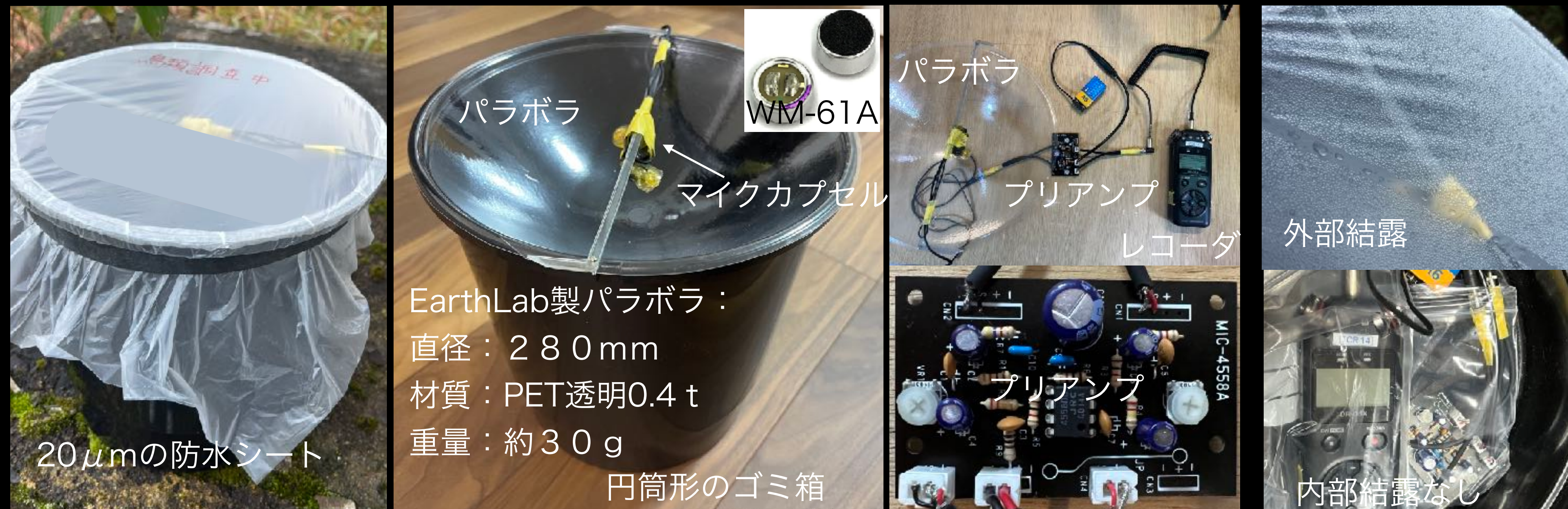
図18 プリアンプ付き耐候性パラボラマイクボックス（パラ箱）の試作
