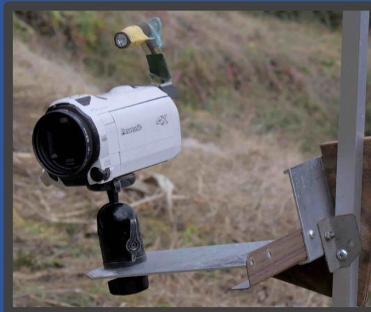
橋桁内部撮影用の ビデオカメラセットと 現地でテスト撮影する様子
